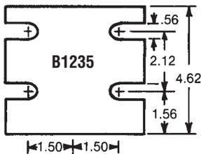
Las bombas de montaje remoto con doble eje requieren un soporte de montaje adicional, N° B1235.
