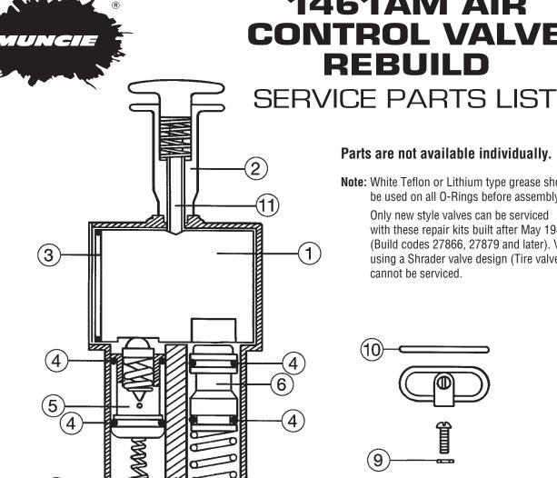
**1461AM AIR CONTROL VALVE** REBUILD
